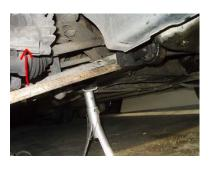
sur cette photo nous voyons très bien l'état du silentbloc de palier de barre stabilisatrice et l'emplacement du silentbloc arrière de triangle
