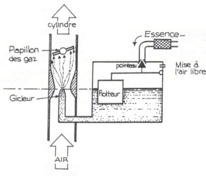
Le carburateur est sujet au **givrage**, qui peut obstruer complètement le conduit d'admission du mélange air – essence, et provoquer l'arrêt du moteur.
