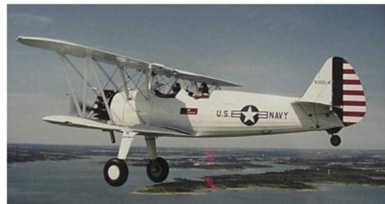
Dans les deux cas, la roulette commandée par les palonniers permet de diriger l'avion au sol.
